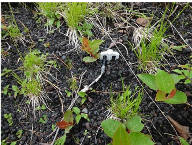
《2018年6月19日・8月27日・他》温度センサーロガーによる気温地表温度地中温度の連続調査・地表温度調査・土壌水分量調査・雨水成分調査などを実施。
